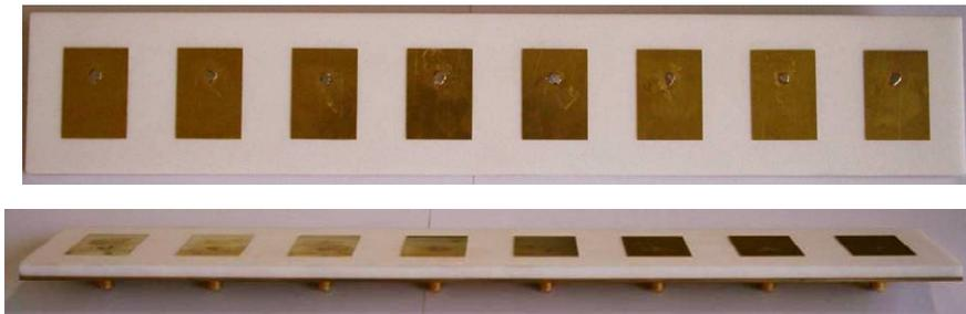
**Figure V.30:** Réseau d'antenne d'émission
