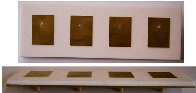
**Figure V.26:** Réseau d'antenne de réception
