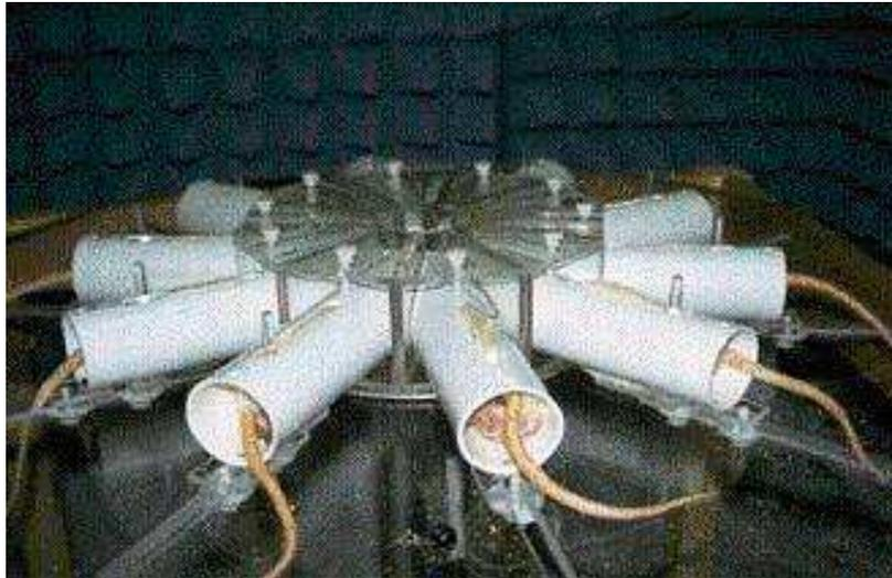
**Figure I.48 : Carrousel pour l'exposition de 10 rats à 835 et 900 MHz**
