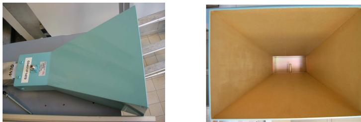
Figure III. 6: Photos de l'antenne cornet et de son excitation.
