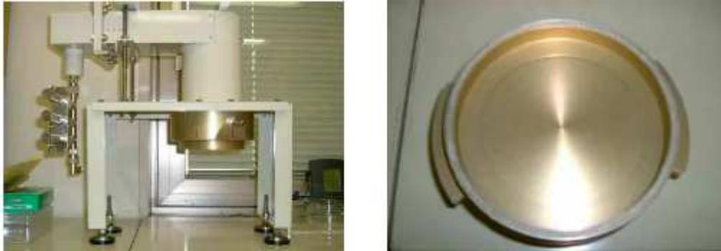
**Figure I.24 : Guide d'onde cylindrique utilisant le mode  $TM_{01}$ , et le court-circuit métallique où est placée la boîte de Pétri [I. 72]**
