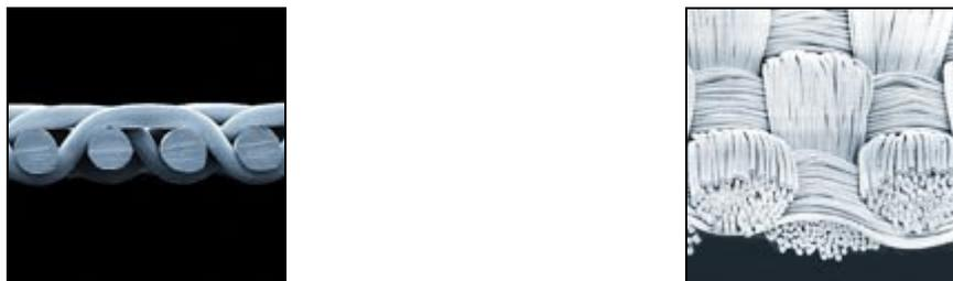
Figure 17 Observation microscopique du tressage des toiles de filtration, à gauche une toile monofilament et à droite une toile multifilament (source [www.sefar-fyltis.com](http://www.sefar-fyltis.com))
