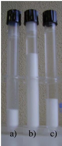
Figure 4.22 : 1) Expérience de sédimentation des suspensions a) alumine 3,3% vol b) 50% m alumine – 50% m silice SP03B, 3,3% vol ; c) silice SP 03B 3,3% vol; 2) hauteur du sédiment (h) et fraction volumique ( \Phi_s ) après 1 mois de sédimentation pour les différentes suspensions testées
