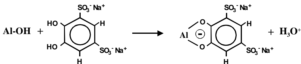
Figure 1.10 : Complexe à sphère interne formé par l'adsorption du Tiron sur la surface de l'alumine [JIA03]
