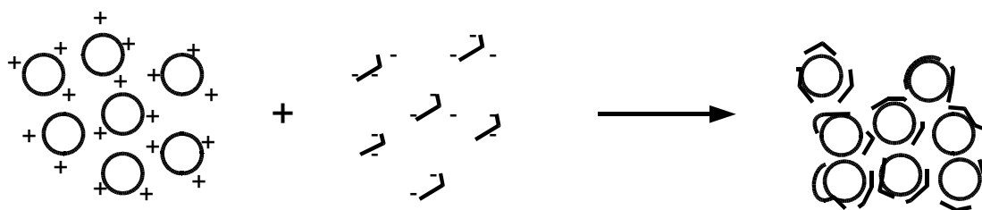
Figure 2.2 : Schéma des résultats de l'interaction entre les particules et les polymères ioniques de polarité opposée
