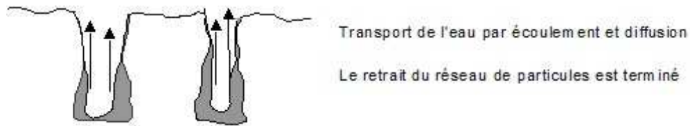
Figure 3.3 : Schéma du processus de séchage dans la 2ème étape de séchage à vitesse décroissante [KRI99]
