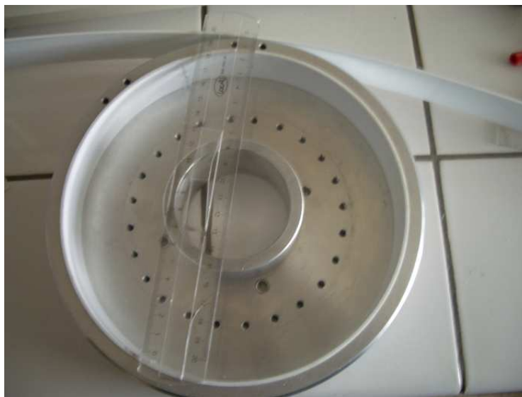
Figure M3 : photographie d'un bol de centrifugation dans lequel est inséré le canal.
