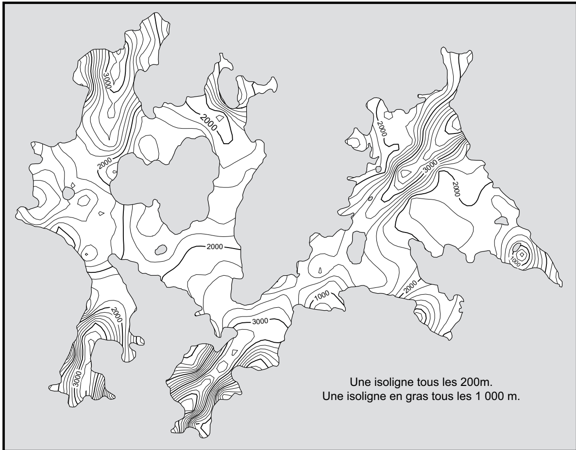
Figure II-13 : Les représentations cartographiques du fetch : isolignes ou dégradé de couleurs L'exemple du fetch effectif sur le lac de Vassivière
