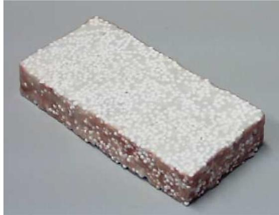
*Figure II-8 : éprouvette contenant 40 % vol. d'inclusions (après polissage des surfaces supérieure et inférieure)*
