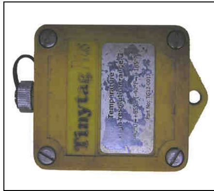
Photo 20 : Thermomètre enregistreur (cliché Carlini)
