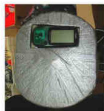
Figure 19 : Présentation de la bouée dérivante avec dérive profonde et G.P.S.
