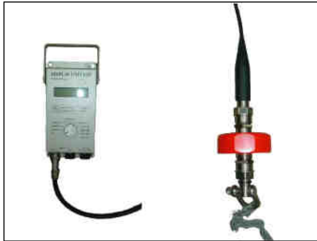
Photo 18 : Courantomètre Doppler, console de lecture et sonde (cliché Carlini)
