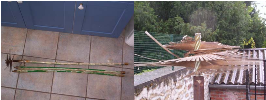
Photographies 1 et 2 : Perche graduée mise au point pour établir la profondeur exacte d'un plan d'eau en un point donné.
