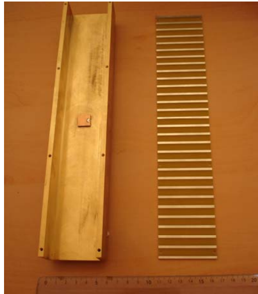
Figure II.28. Détails du prototype de l'antenne sectorielle
