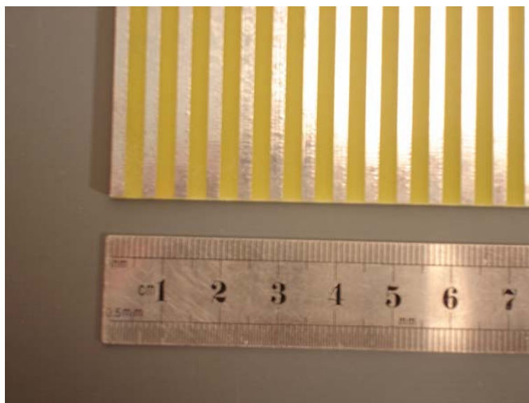
Figure III.12. Photographie de la structure BIE du prototype
