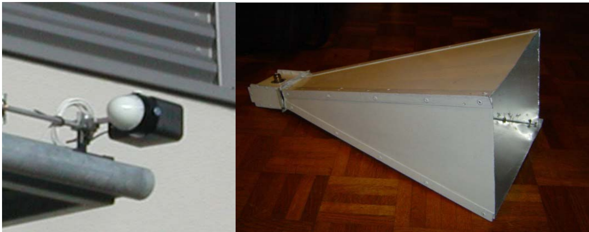
Figure II.6. Exemple d'antenne à lentille diélectrique et de cornet
