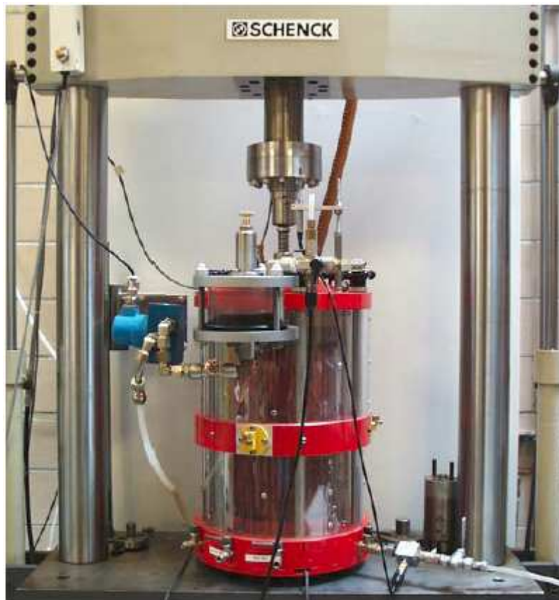
Figure 6 : Une vue de l'appareil triaxial du LCPC de Nantes.
