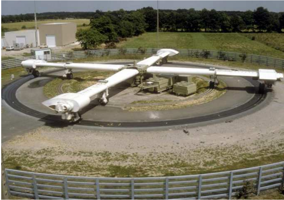
Figure 1 : Manège de fatigue du LCPC de Nantes.
