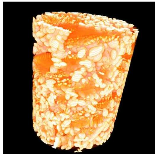
Figure 4.3 : Représentation 3D de la microstructure de l'AZS obtenue par tomographie X<sup>[2]</sup>
