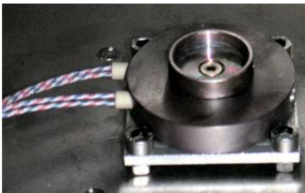
FIG. 22 Porte échantillon et table de chauffage
