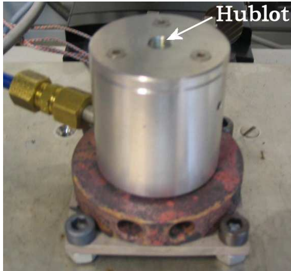
FIG. 20 Boîte étanche et hublot pour le passage du laser
