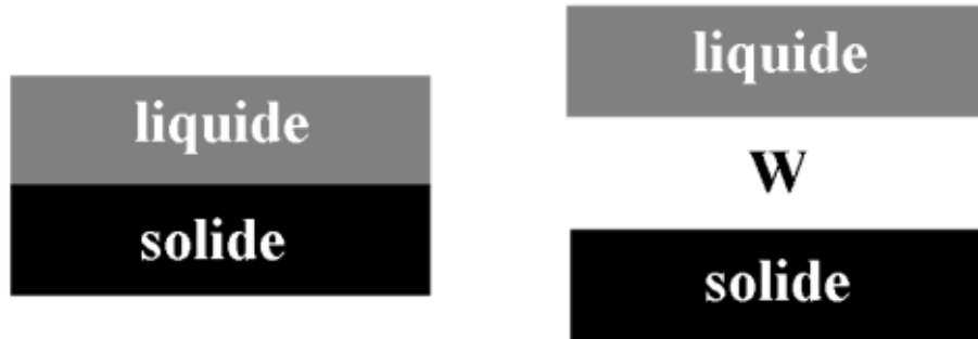
FIG. 14 Séparation de l'interface à l'aide du travail d'adhésion W
