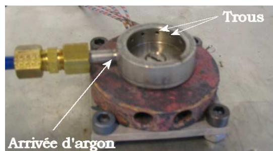
FIG. 19 Porte échantillon pour atmosphère d'argon
