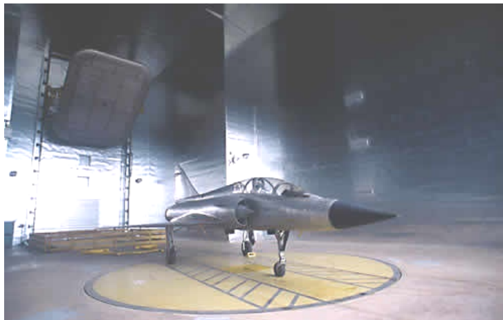
Figure 38 : chambre de mesure Hypérion du CEG ; un avion de combat teste ici sa vulnérabilité aux MFP
