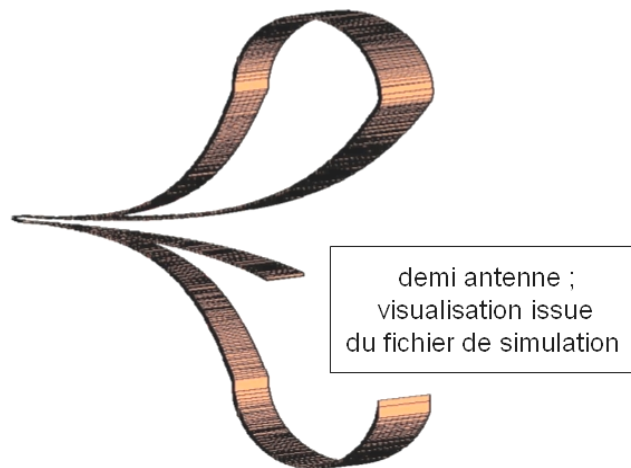
Figure 116 : antenne issue d'un fichier de simulation, symétrie effectuée dans le plan E
