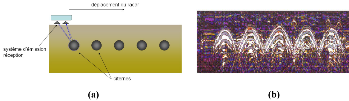
Figure 49 : principe de mesure (a) - : image GPR de citernes enterrées (b)
