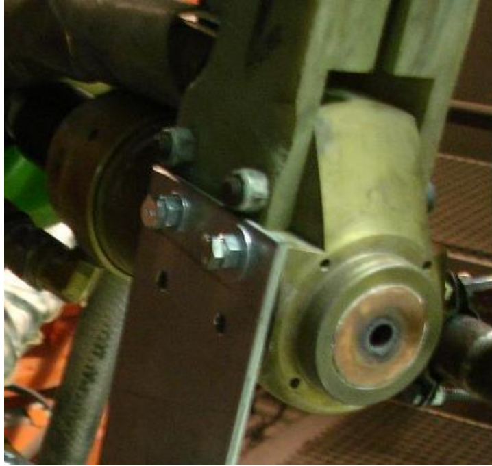
Figure 9 : Torche Plazjet Internal de Tafa Praxair présente sur l'installation de Pierrelatte
