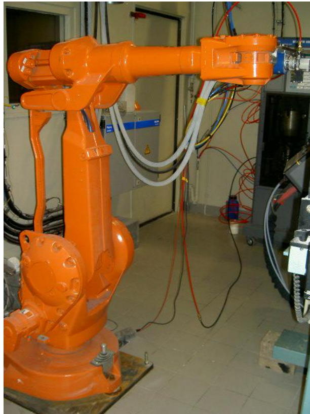
Figure 18 : Robot de type A.B.B. IRB 2400 supportant la torche Plazjet utilisée dans l'installation
