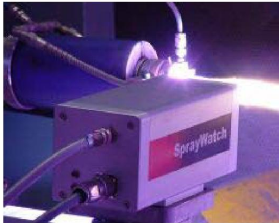
Figure 19 : Caméra du système Spraywatch en cours d'utilisation
