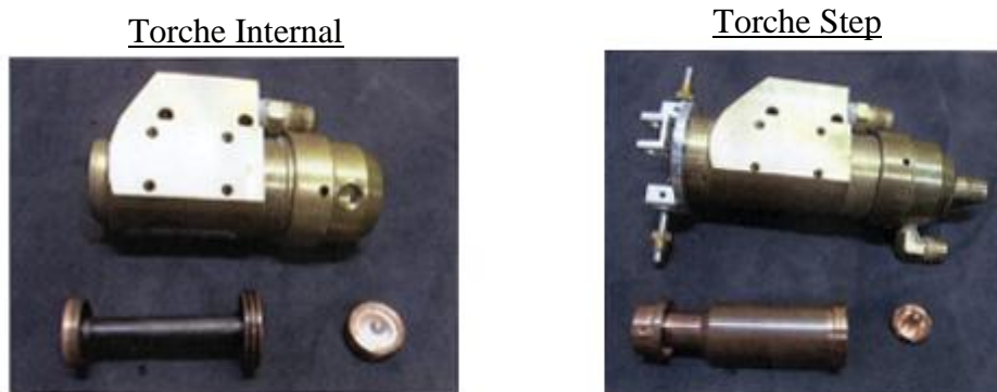
Figure 31 : Photographies des deux variétés de torche Plazjet fabriquée par Tafa avec pour chacune d'elle le couple Anode-Cathode lui correspondant [87]
