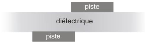
**Fig. 1-9 : Exemple de coupe transverse d'une carte simple couche, double face, sans plan de masse**
