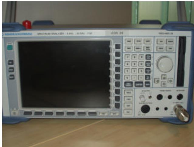
**Fig. 2-17 : L'analyseur de spectre utilisé pour mesurer la puissance du champ**
