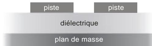
**Fig. 1-10 : Exemple de coupe transverse d'une carte simple couche avec plan de masse**
