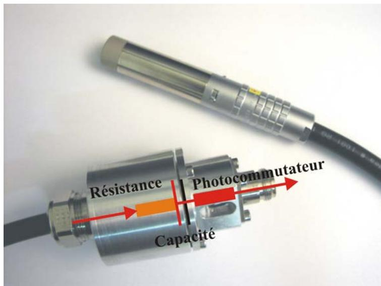
Figure III.29 : Photographie du générateur ULB pour le démonstrateur de radar ULB.
