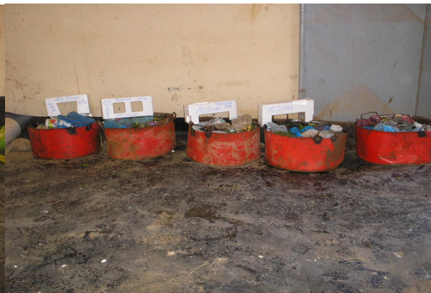
Annexe 7' : Dispositif expérimental - Détermination de la capacité de rétention en Dynamique (colonne) et statique
