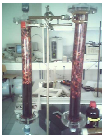
Figure 5b : Copeaux de bois en colonne
