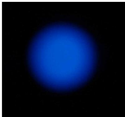
Figure 14 : Photographie d'une DELO ITO/PEDOT-PSS/  $\alpha$ -NPB /Ca/Al
