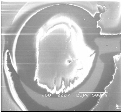
Figure 13 : Observation au M.E.B. d'un dépôt d'argent réalisé avec un faisceau d'ions de densité de courant égale à  $70 \mu\text{A}\cdot\text{cm}^{-2}$ .
