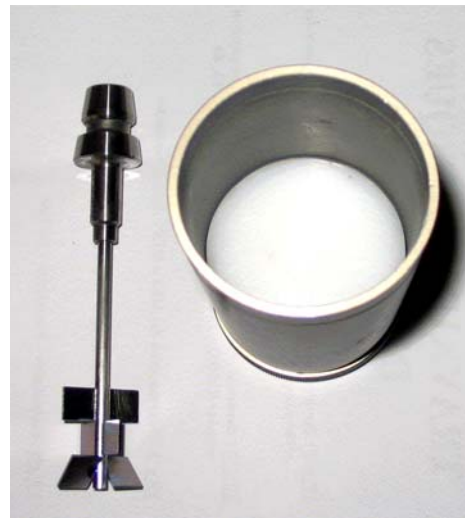
Figure 17 : Cellule de mesure ST24-1D/2V-Q0 à pâles
