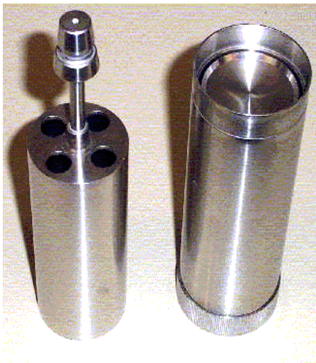
Figure 16 : Cellule de mesure Z1 DIN à double entrefer
