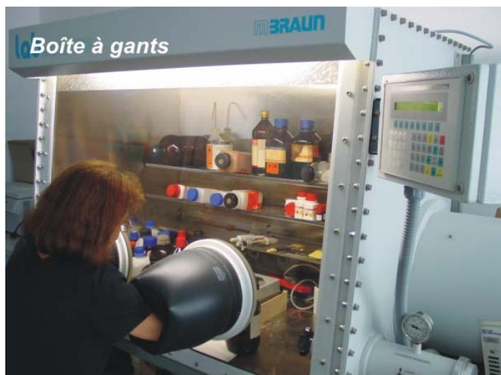
Figure 74 : Photographie d'une boîte à gant avec circulation d'azote sec.
