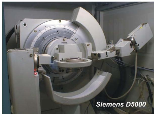
*Figure 27 : Photographie d'un diffractomètre Bragg-Brentano de géométrie symétrique.*
