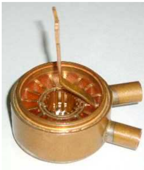
Figure 32 Anode de la cavité résonnante du AMN245 avec l'antenne de la transition coaxiale.
