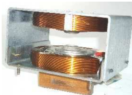
Figure 34 Circuit magnétique du AMN245 (aimants, bobines et pièces polaires).
