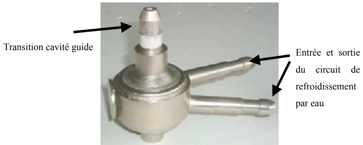
Figure 31 Cavité résonnante du AMN245 avec circuit de refroidissement à eau et transition vers guide.
