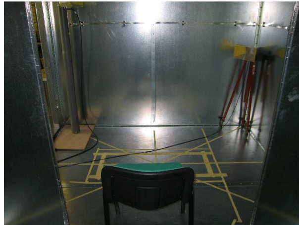
Figure 5.14 : Photo d'une partie de l'environnement de propagation utilisé pour les mesures : la chambre réverbérante du laboratoire XLIM
