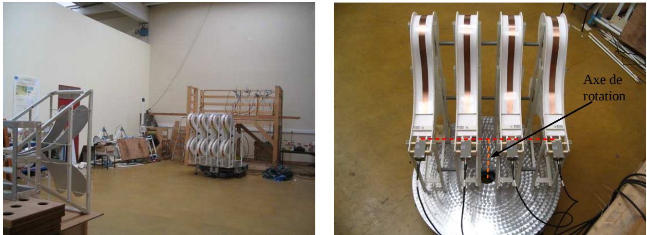
Figure 172 : Dispositif de mesure du diagramme de rayonnement
