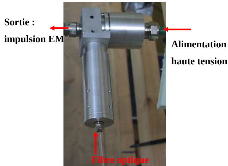
Figure 60 : Photocommutateur réalisant l'alimentation du réseau d'antenne de RUGBI
