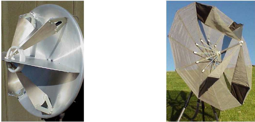
Figure 82 : Antennes FRI-IRA-3 et CIRA-2 développées par Farr Research
