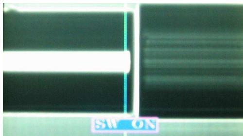
Figure III-10 : Visualisation sur l'écran de la soudeuse Sumitomo T36 du positionnement manuel des fibres monomode - microstructurée à 6 trous, en optimisant le signal transmis
