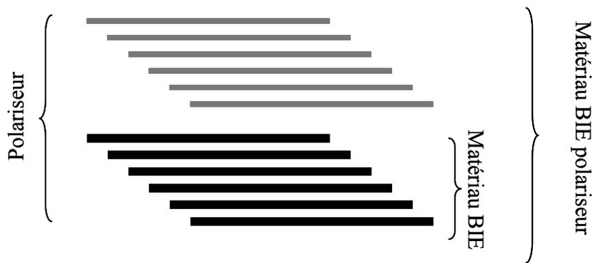
**Figure IV.11** : Obtention du matériau BIE polariseur.
