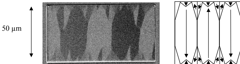
Figure IV-7 : Configuration des domaines magnétiques observés par MOKE pour une couche de FeHfN de 100 nm d'épaisseur (configuration domaines de fermeture).
