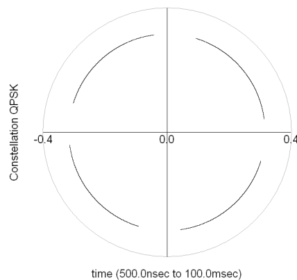
Figure 3-25 – Impact du bruit de phase seul sur une constellation QPSK [ 0 ; 100 msec ]
