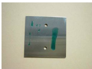
Figure 1-32 : Etalement de l'encre sur un échantillon avant (partie gauche de l'échantillon) et après (partie droite de l'échantillon) traitement par le Plasma pen (Tepla-PVA) 22 .
