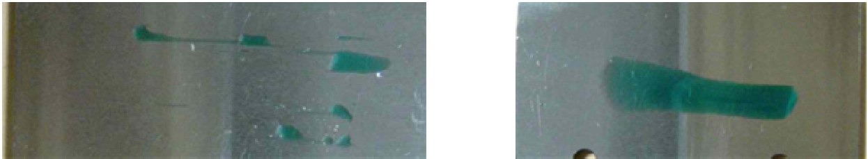
Figure 3-3 : Principe de la mesure d'énergie de surface par étalement de l'encre. A gauche, la tension de surface de l'encre est trop élevée par rapport à l'énergie de surface du substrat. A droite, l'énergie superficielle de l'échantillon est supérieure ou égale au calibre de l'encre.
