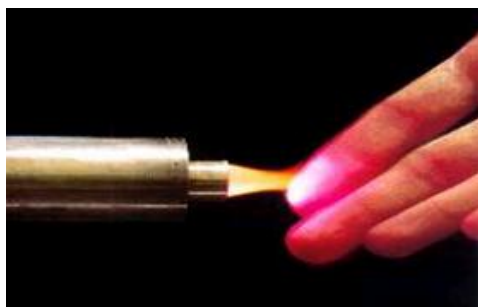
Figure 1-30 : Le groupe du Professor Hicks (UCLA: Chemical Engineering Department, Semiconductors Manufacturing) a développé l'APPJ pour le nettoyage, la gravure et le dépôt. Sur la photo, la flamme froide (T~75°C) est en contact avec la main d'un étudiant. 107
