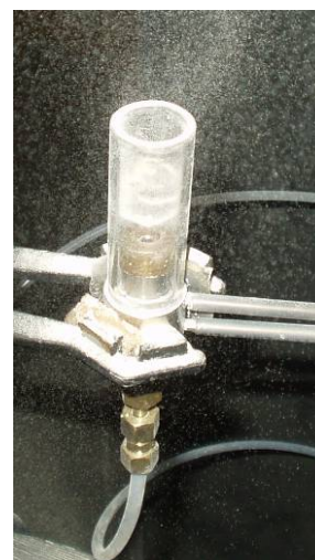
Figure 2-39 : Trajectoire du gaz injecté de façon tangentielle inclinée
