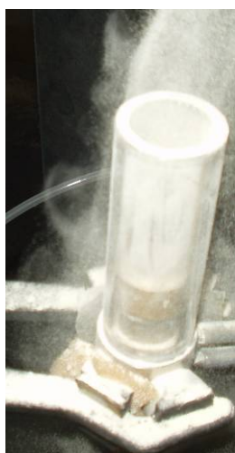
Figure 2-37 : Trajectoire du gaz injecté verticalement
