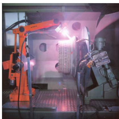
Figure 1-36 : Dépôt d'une large gamme de matériaux (même céramiques) par projection plasma totalement automatisée (gauche : Plasma & Thermal Coatings Ltd 117 , droite : Plasma Giken co 118 ).
