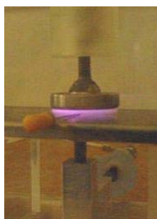
Figure 1-29 : Photo d'un plasma froid stérilisant un outil dentaire à la pression atmosphérique à Loughborough University (Plasma & pulsed power research group) 98
