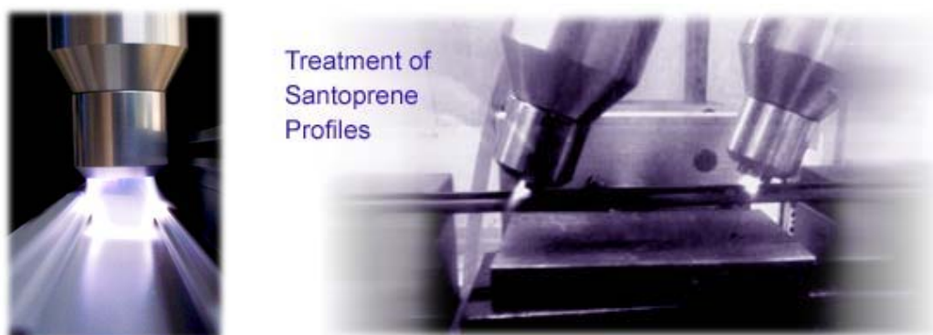
Figure 1-33 : Traitement en ligne Plasmatreat® du EPDM/TPE extrudé avant collage 24 .
