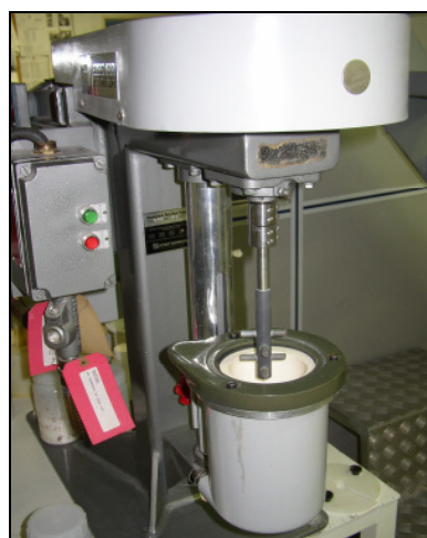
figure V-2 : Attriteur utilisé dans le cadre de cette étude, modèle Szegvari-Reeves, Union Process
