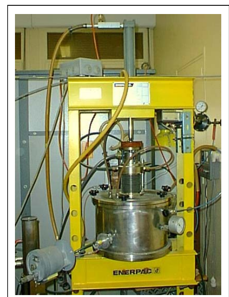
Figure II.1 : Dispositif de frittage sous charge [SEN99]
