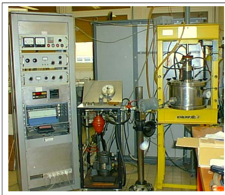
Figure II.1 : Dispositif de frittage sous charge [SEN99]
