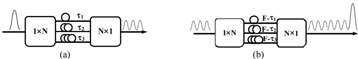
Figure II-8: schémas : (a) d'un codeur ; (b) d'un décodeur optiques à ligne à retard pour les liaisons DS-OCDMA
