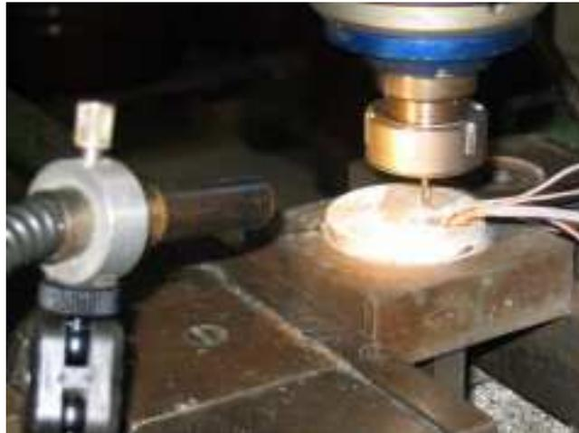
Figure II-23 : photographie du dispositif de mesure des contraintes résiduelles sans les dépôts, méthode du trou incrémental. UTT-LASMIS.
