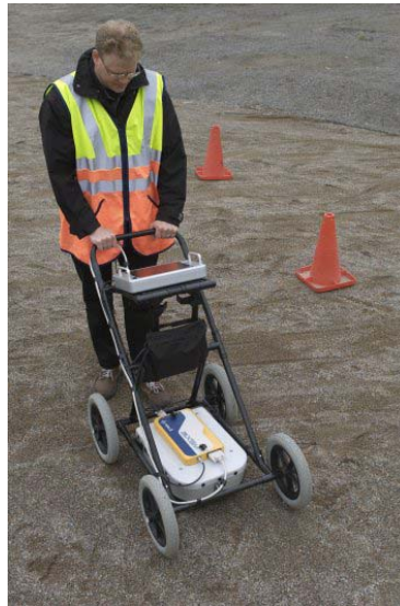
Figure 2.16 : Radar RAMAC monté sur le chariot RAMAC GPR SCART.[23]
