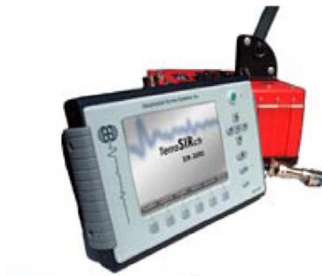
Figure 2.22 : Unité d'acquisition du SIR-3000 (premier plan) et une antenne compatible avec cette unité.
