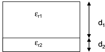
Figure A3. 4 : Calcul de la permittivité équivalente [38]
