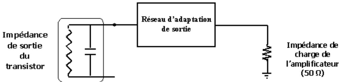
Figure II-26 : Rôle du circuit d'adaptation de sortie
