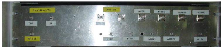
Figure I-7: Tiroir de modulation et de démodulation – vue externe.
