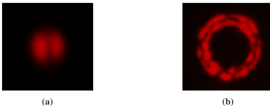
Figure III-16 : Imagerie en champ proche de la face de sortie de la FDCC n°1 à 633nm pour une injection centrée (a) et décalée (b).
