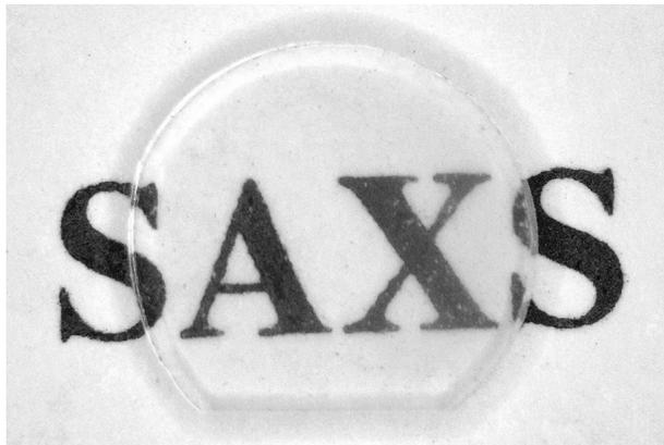
Fig. 23 : observation d'un échantillon monolithique ayant subi un traitement thermique d'une heure à 600°C. L'image est agrandie quatre fois par rapport aux dimensions réelles de l'objet.
