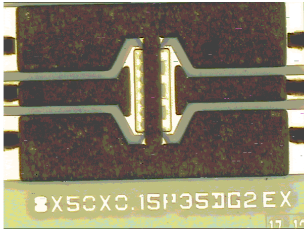
Figure 1–25 : photographie d'un transistor de développement de grille 8x50µm sur technologie SiC du process TIGER
