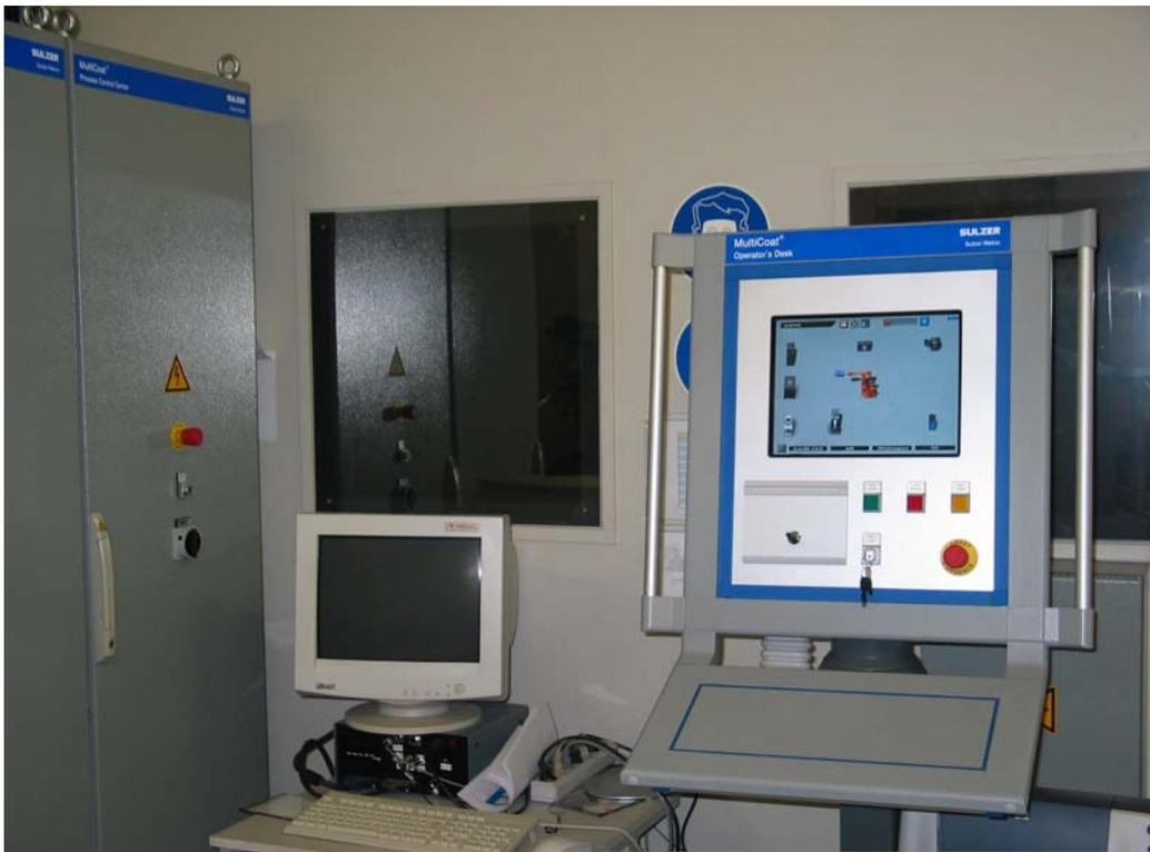
Figure II-3 : vue d'ensemble: armoire de contrôle des gaz (gauche), dispositif de contrôle du SDC (centre) et Multicoat (droite)
