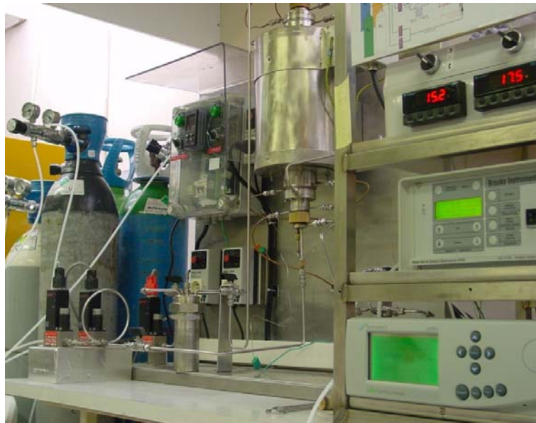
Figure IV.5 : Vue générale du banc de test pour la mesure des flux de perméation de l'oxygène au travers des membranes
