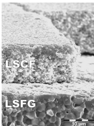
Figure IV.21 : Micrographie de l'interface couche dense / couche catalytique (vue en perspective cavalière) d'une membrane LSCF+LSFG après 1 semaine de test sur le bâti
