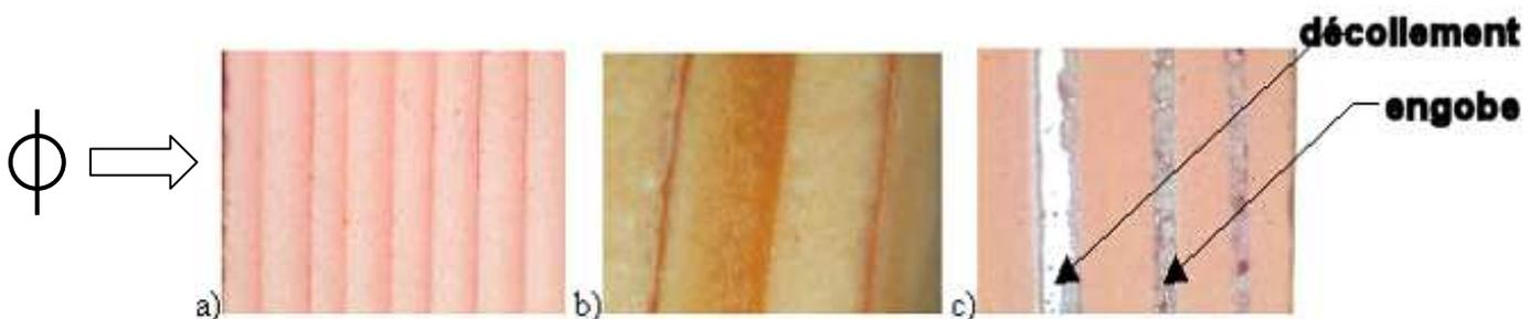
Figure 32 : Aspect des multicouches élaborées : a) et b) par thermocompression ; c) par encapsulage
