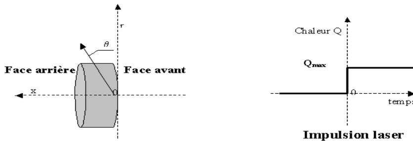
Figure 5 : Représentation graphique de l'échantillon en coordonnées polaires et de l'impulsion laser
