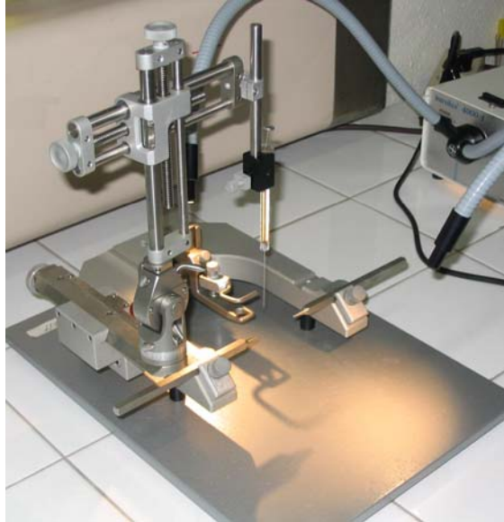
Figure 27. Photo de l'appareil de stéréotaxie.
