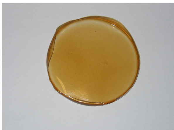
Figure 77 : Photographie d'un film de xylane estérifié par l'acide laurique.
