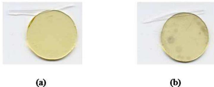
**Figures 75.a et b. Photographies du verre 84,15%  $\text{TeO}_2$  – 14,85%  $\text{WO}_3$  – 2%  $\text{SbO}_{1,5}$  : (a) avant poling ; (b) après poling ( $T = 295^{\circ}\text{C}$ ,  $U = 4,5 \text{ kV}$ ,  $\tau = 2 \text{ h}$ )**
