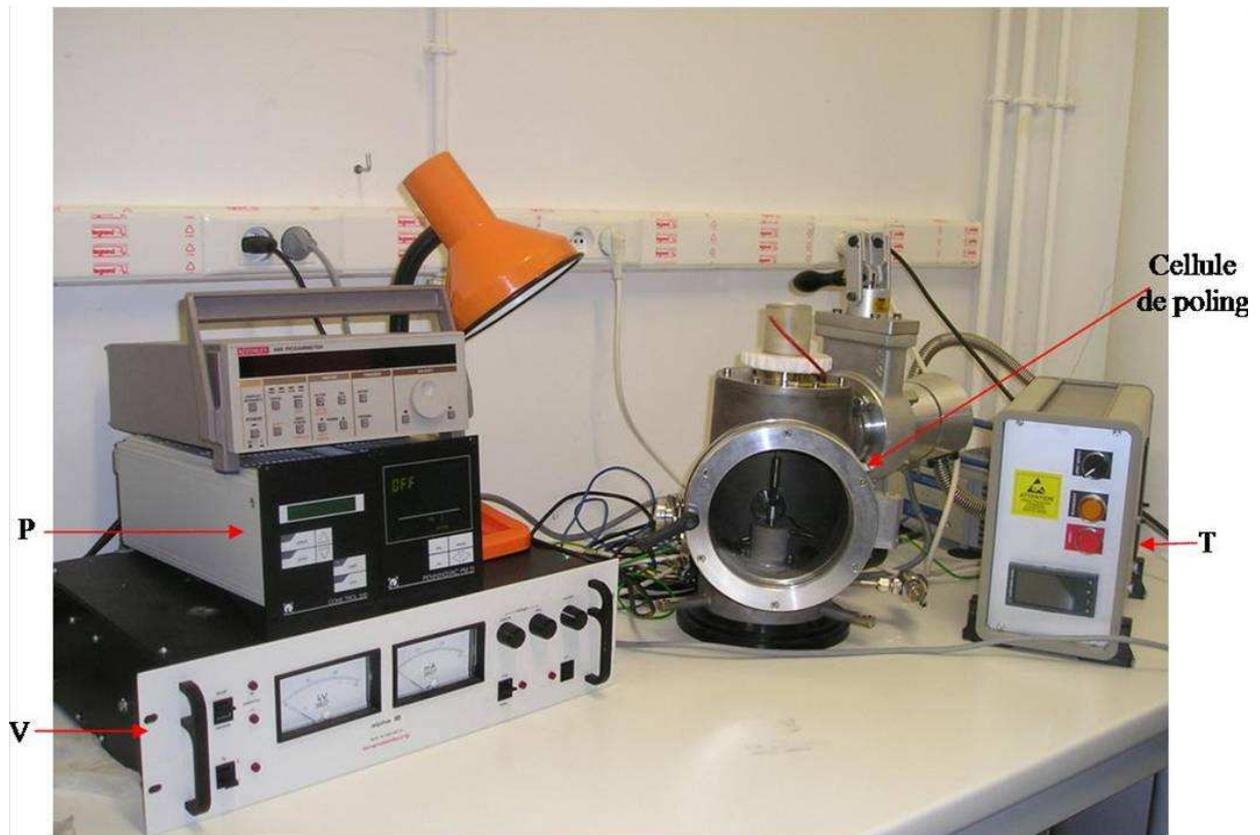
**Figure 26. Vu d'ensemble du montage du poling thermique ainsi que les appareils de contrôle (alimentation haute tension (V), régulateur de température (T), jauge de vide secondaire (P))**
