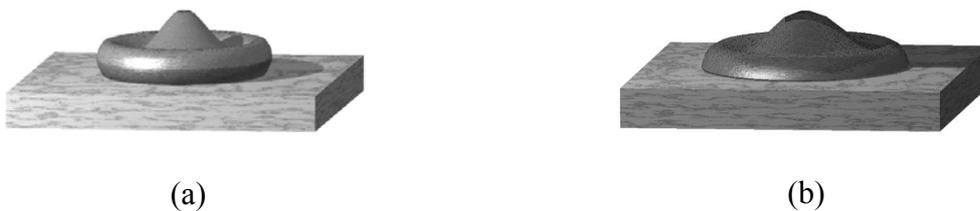
Figure 1–14 : Schémas des lamelles étalées sur le substrat. Système non-mouillant (a) et système mouillant (b).
