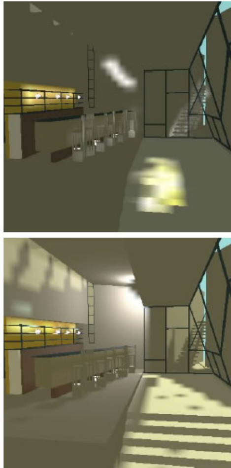
Figure 35. Calcul de l'émittance de certains carreaux fixés a priori, carreaux jouant le rôle de sources lumineuses et approchant le mieux possible une spécification de l'éclairage donnée par un utilisateur (Images issues de [SDSAG93]).
