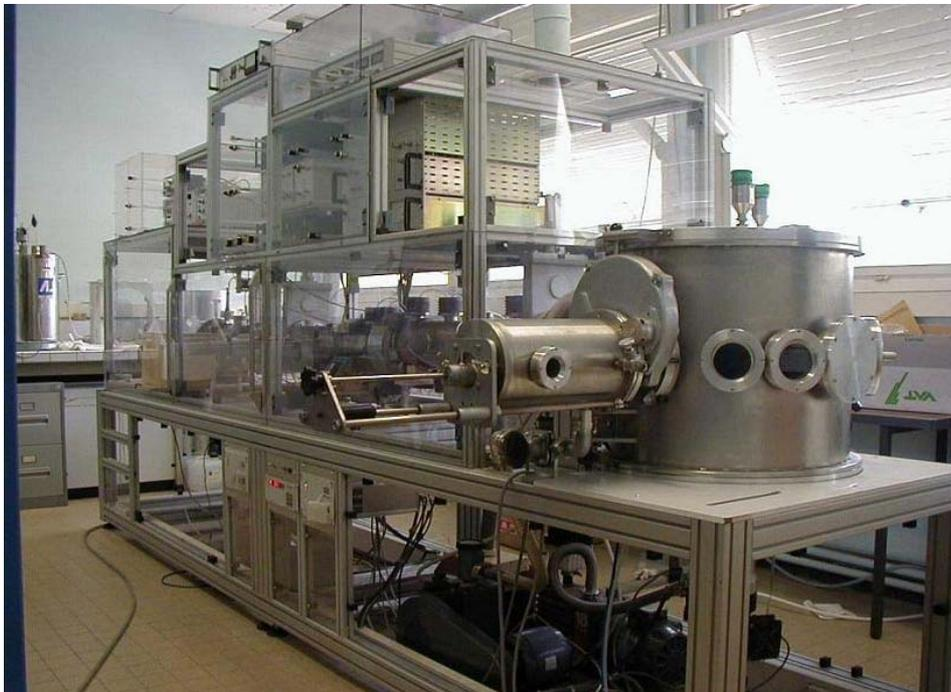
Figure 1 : vue d'ensemble de l'implanteur basse énergie.
