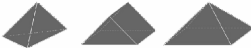
Figure 36 : formes géométriques utilisées pour le maillage : tétraédrique, prismatique et pyramidal.
